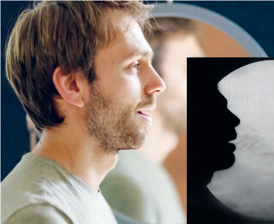
In der Pandemie galt das Singen als gefährlich. Im Schlierenspiegel machten Forscher am Institut für Mechanik und Fluidodynamik der TU Bergakademie Freiberg die Bewegung der Atemluft beim Ausatmen sichtbar.
